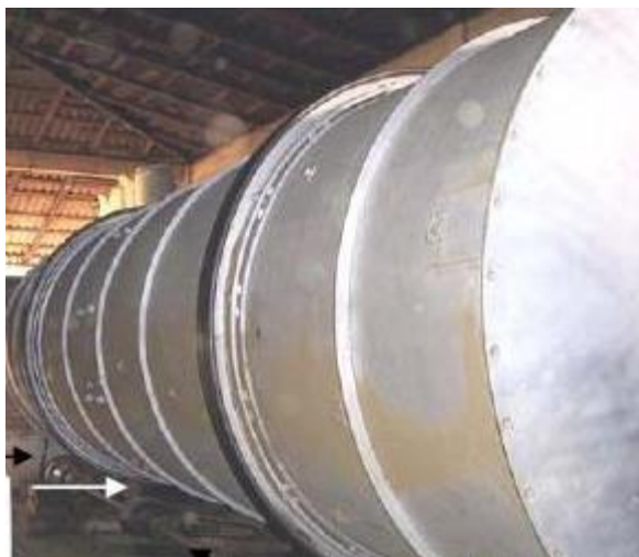
Figura 6. Sapecador rotativo de erva-mate. Fonte: Maccari Junior, 2005.
